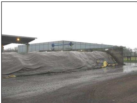
Stabilizacja tlenowa w przyzmach przykrytych membraną Goretex, instalacja Hantsch, stabilizacja pod wiatr (proj. HEKO), system membranowy BIODEGMA (fot. proGEO)
