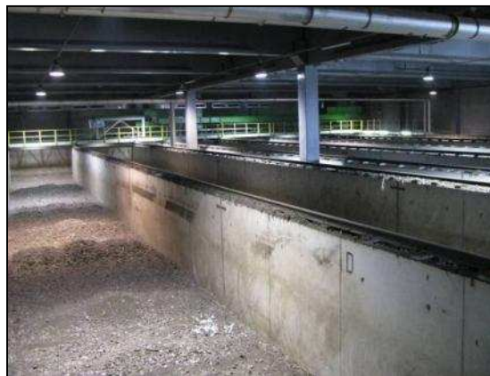
Stabilizacja tlenowa dynamiczna w hali firmy SCT, BIOFIX firmy Sutco oraz Backhus (fot. proGEO)
