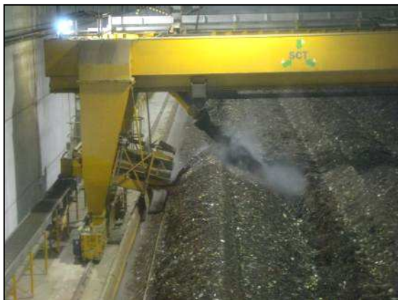
Stabilizacja tlenowa dynamiczna w hali firmy SCT, BIOFIX firmy Sutco oraz Backhus (fot. proGEO)
