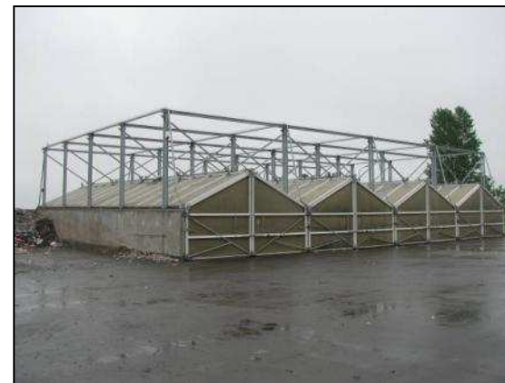
Stabilizacja tlenowa w przyzmach przykrytych membraną Goretex, instalacja Hantsch, stabilizacja pod wiatr (proj. HEKO), system membranowy BIODEGMA (fot. proGEO)
