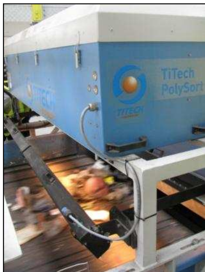
Separator optopneumatyczny – RADKOM Radom, separator konwekcyjny – ALBA Wrocław, separator balistyczny GEDESMA Pinto (Hiszpania), foto proGEO
