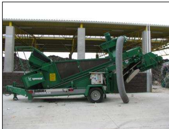
Sito i urządzenie doczyszczające firmy KOMPTECH, paczkowanie kompostu (fot. proGEO)
