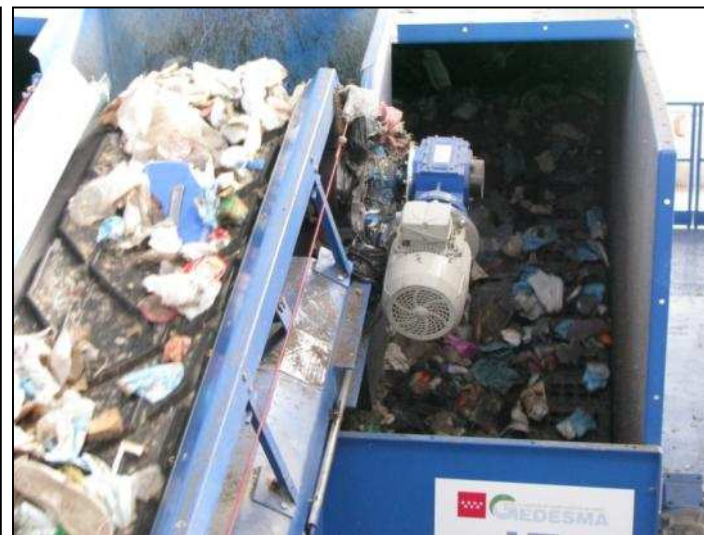
Separator optopneumatyczny – RADKOM Radom, separator konwekcyjny – ALBA Wrocław, separator balistyczny GEDESMA Pinto (Hiszpania), foto proGEO
