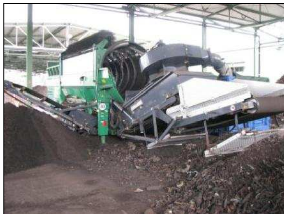
Sito i urządzenie doczyszczające firmy KOMPTECH, paczkowanie kompostu (fot. proGEO)
